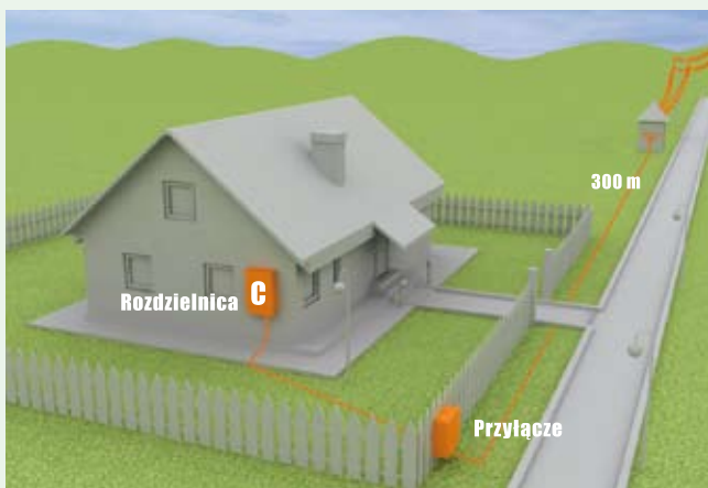
Parterowy budynek bez instalacji odgromowej, zasilany linią kablową. Odległość od trafo 300 m. Montaż ogranicznika przepięć klasy C (II) typu SPC-S-20/280/.. lub klasy B+C (I+II) typu SPB-12/280/..
