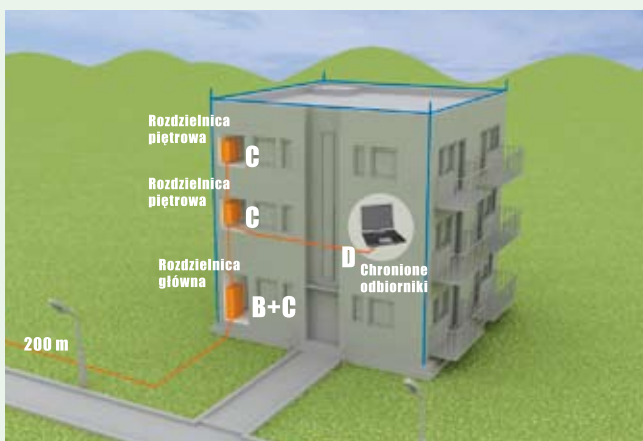
Budynek wielopiętrowy z instalacją odgromową, zasilany linią kablową. Montaż ograniczników przepięć: rozdzielnica główna – klasa B+C (I+II), typ SP-B+C/3.. rozdzielnice piętrowe – klasa C (II), typ SPC-S-20/280/.. Przy czułych urządzeniach (komputery, serwery itp) zalecany montaż ogranicznika przepięć klasy D (III), jak najbliższej chronionego urządzenia.
