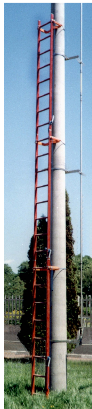
Drabina izolacyjna z segmentów SI-22
