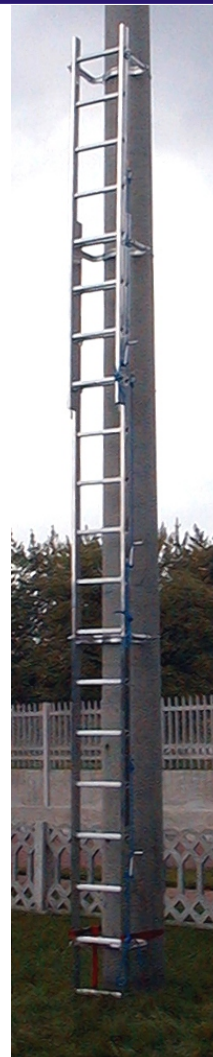
3. Regulacja wysokości drabiny nasadzonym przęsłem górnym
