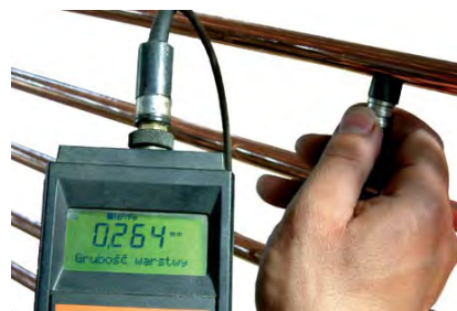
Rys. 12 Pomiar grubości powłoki pomiedziowanych uziomów pionowych Galmar o minimalnej grubości powłoki 250 µm
