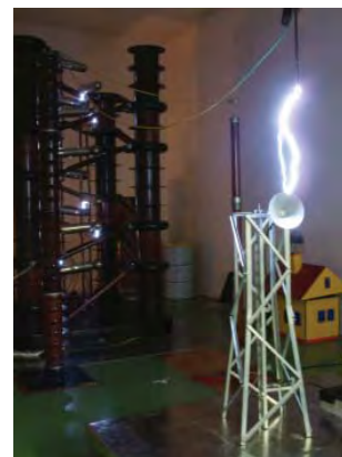
Symulacja wyładowań atmosferycznych w model wieży GSM w laboratorium wysokonapięciowym Galmar
