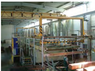
Linia do produkcji uzimów pomiedziowanych z powłoką miedzi o grubości min. 0,250 mm
