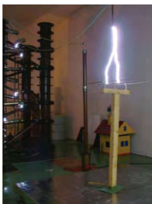
Symulacja wyładowań atmosferycznych w model linii napowietrznej w laboratorium wysokonapięciowym Galmar
