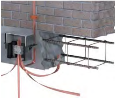
Rys. 9 Prawidłowo wykonane połączenie uziomu sztucznego (system pomiedziowany GALMAR) z uziomem fundamentowym
