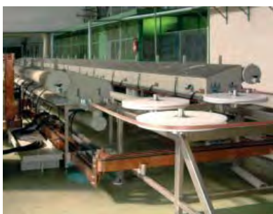
Linia galwaniczna do produkcji drutu i taśmy pomiedziowanej z powłoką miedzi o grubości 0,070 mm
