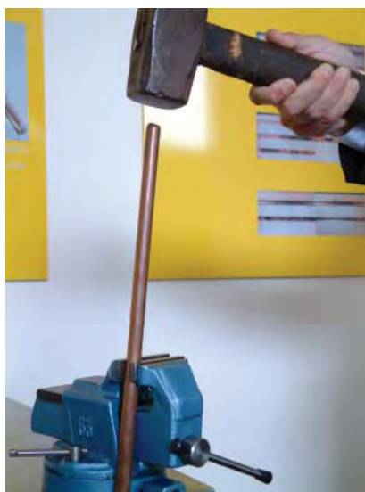
Próba zdzierania powłoki miedzianej w imadle
